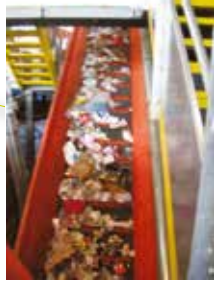
Un tapis achemine les emballages dans la cabine de pré-tri.
