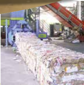
Une presse met en "balles" les emballages et les prépare ainsi pour le transport.
