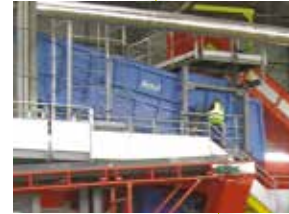
Un crible sépare les corps creux (bouteilles en plastique, boîtes de conserve, ...) des corps plats (papiers, cartonnettes, ...) et les orientent vers deux cabines de tri distinctes.
